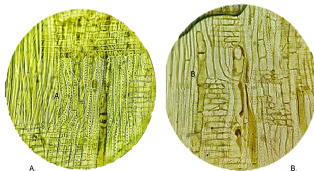
Figura 2. Corte Radial: A) 100X. Ponteadoras areoladas simples, raios homogêneos B) 100X. Presença de óleos nos elementos de vaso.
