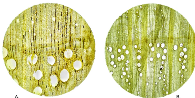
Figura 3. Corte transversal: A) 40X. Porosidade anular y anel de crescimento. B) 40X. Diferencias de anéis.
